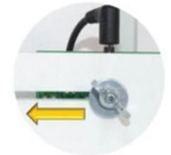
⑤ Détermination du composant permettant d'augmenter ou diminuer la vitesse de déplacement du portail :
